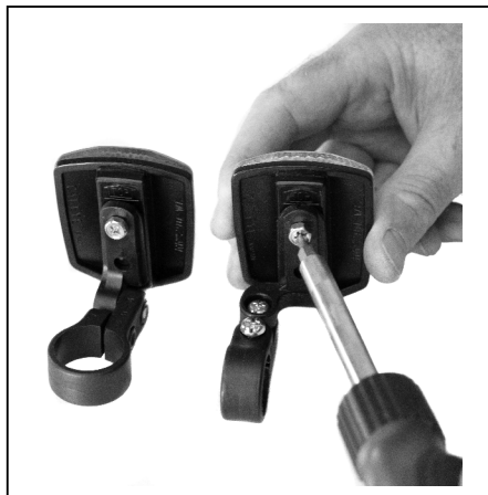
montage van de reflectoren
